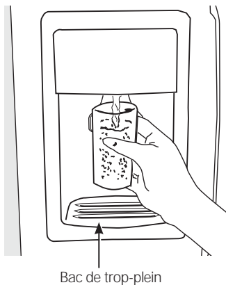
Bac de trop-plein
